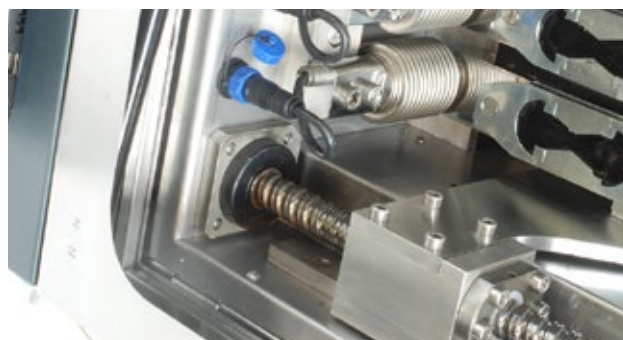
Detalle de 81-PV10B02 y PV10C12 con cuatro células de carga 81-PV10020 y moldes de probetas
