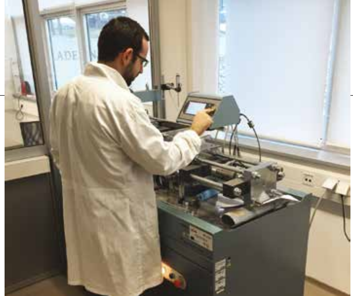
13. Il momento dell'impostazione dei parametri di prova con l'attrezzatura per la prove di taglio diretto
