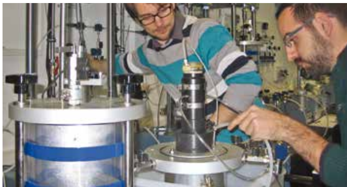
4. La preparazione di un provino di sabbia compattata
