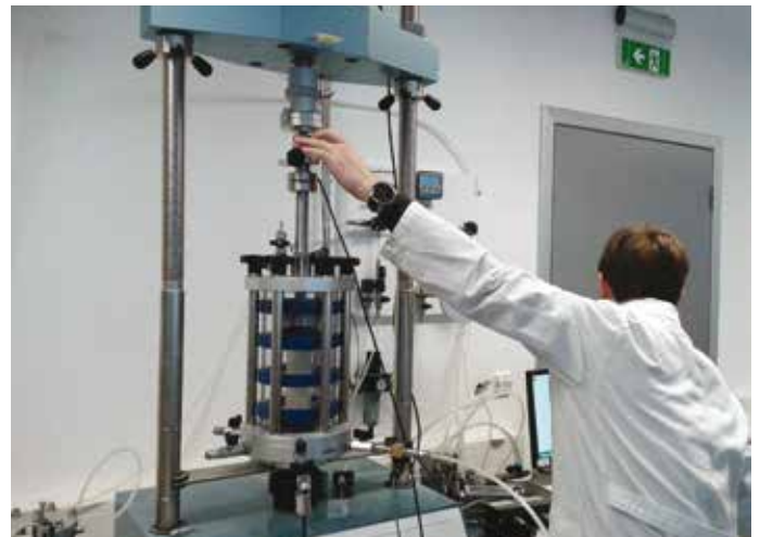
10. Il settaggio del sistema per prove triassiali cicliche
