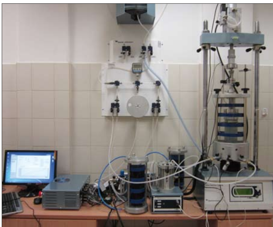
Fig.3 - Sistema Dynatriax completo
