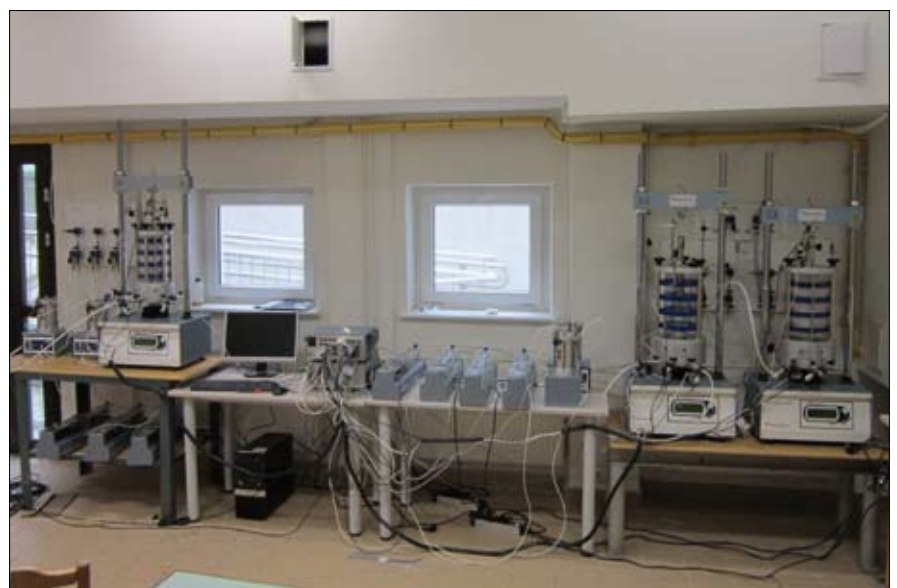
Fig.2 - Sistema Autotriax, costituito da tre presse Trittech 50 e tre celle triassiali
