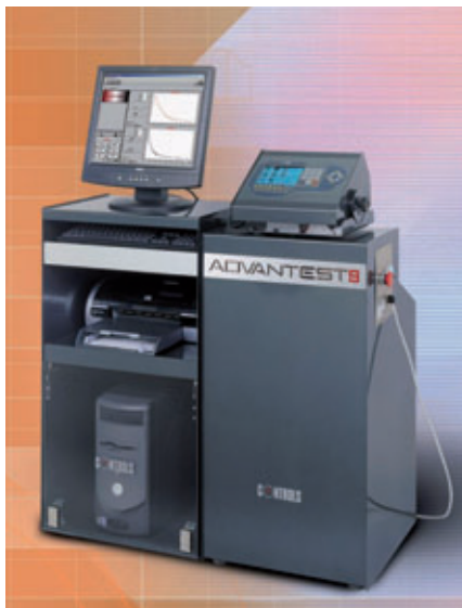
Рис. 2: Модель 50-C9842 ADVANTEST 9. Сервогидравлический автоматический блок управления
