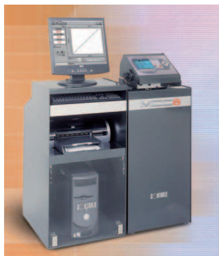
Рис. 2: Серво-гидравлический блок управления МСС 8
