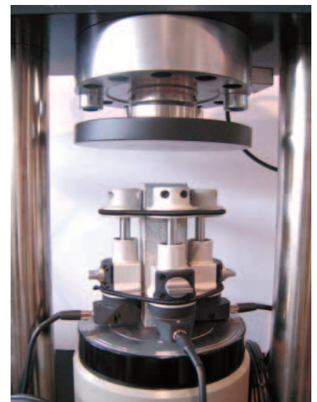
Рис. 1: Испытательные образцы из бетона и раствора, готовые к измерению МУ при помощи высокоточных датчиков 55-C0222/F
