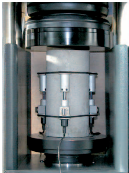
Рис. 1: Испытательные образцы из бетона и раствора, готовые к измерению МУ при помощи высокоточных датчиков 55-C0222/F
