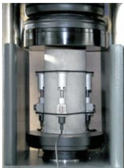
1: Próbkę betonu i zaprawy, gotową do pomiaru modułu sprężystości za pomocą wysoce precyzyjnych czujników 55-C0222/F.
