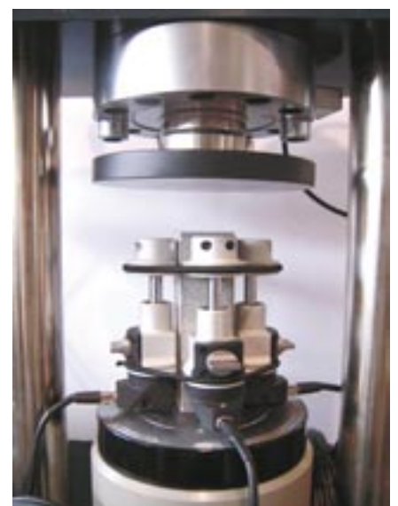
1: Próbkę betonu i zaprawy, gotową do pomiaru modułu sprężystości za pomocą wysoce precyzyjnych czujników 55-C0222/F.
