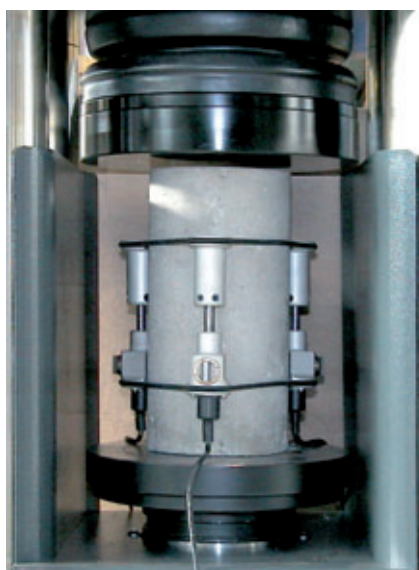
Abb. 1: Beton- und Mörtelproben, messbereit mit den hochpräzisen 55-C0222/F-Sensoren für den EM-Test
