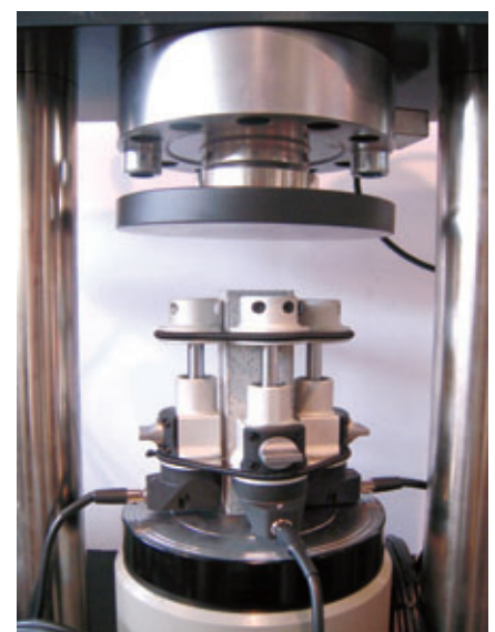
Abb. 1: Beton- und Mörtelproben, messbereit mit den hochpräzisen 55-C0222/F-Sensoren für den EM-Test
