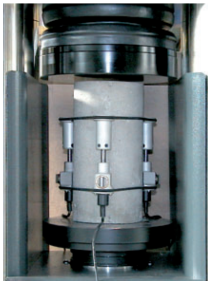
Ill. 1: Éprouvettes béton et mortier équipées d'extensomètres 55-C0222/F pour essai ME.
