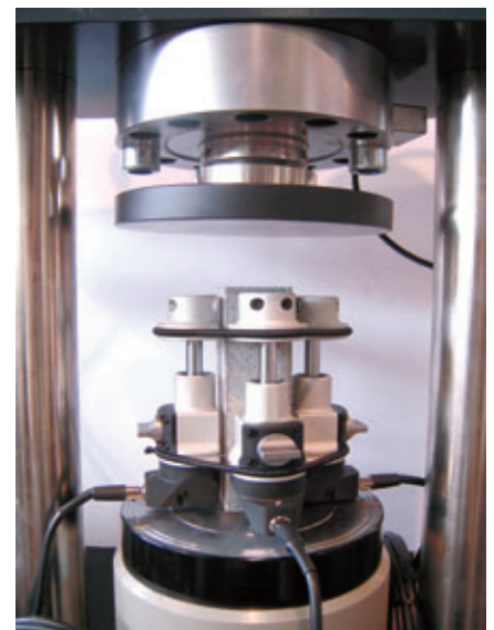
Ill. 1: Éprouvettes béton et mortier équipées d'extensomètres 55-C0222/F pour essai ME.
