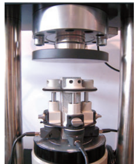
Fig. 1: Provini di calcestruzzo e malta strumentati con i sensori 55-C0222/F per la prova di Modulo Elastico
