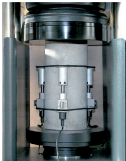
Fig. 1: Provini di calcestruzzo e malta strumentati con i sensori 55-C0222/F per la prova di Modulo Elastico
