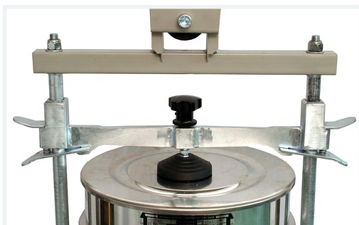
Détail du système de blocage.
