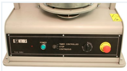
Panneau frontal avec interrupteur et minuterie. Egalement visible sur cette photo, plaque de base.
