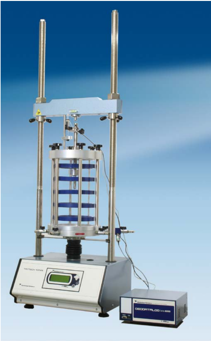
28-WF4010, presse 100 kN avec cellule triaxiale, cellule de charge externe et capteur de déplacement.
