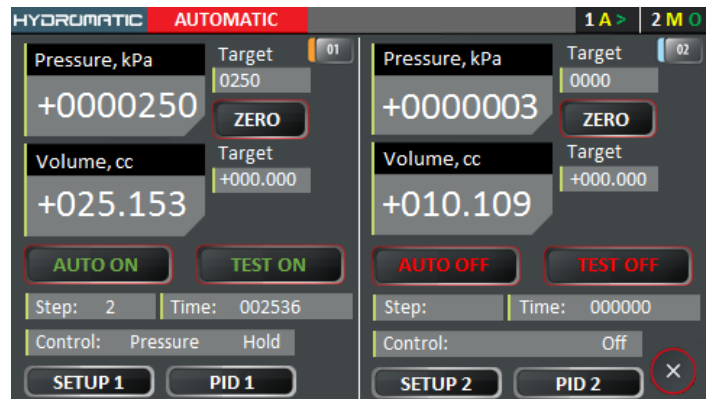
Auto Control (capture d'écran) : Exécution automatique de pas préprogrammés de pression et/ou de changement de volume
