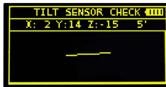
Exemple d'affichage du scléromètre digital - Mesure et indication de l'angle d'impact effectif défini par l'inclinomètre triaxial
