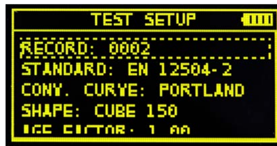
Exemple d'affichage du scléromètre digital - Paramétrage essai
