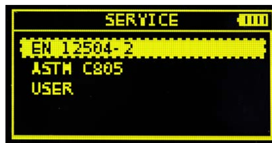
Exemple d'affichage du scléromètre digital - Sélection Norme
