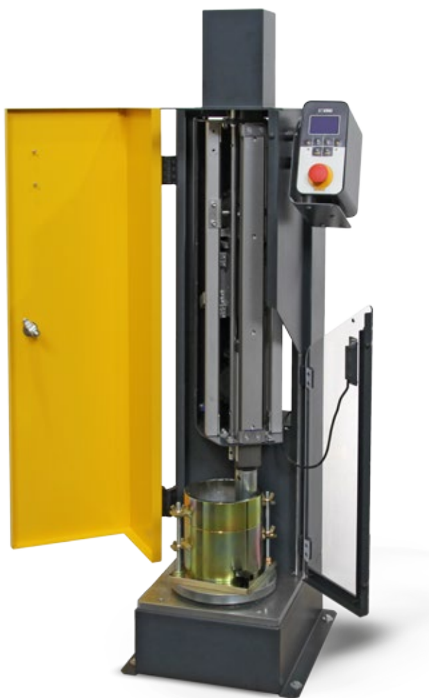
Compacteur automatique Proctor/CBR programmable avec potière avant ouverte et portière transparente
