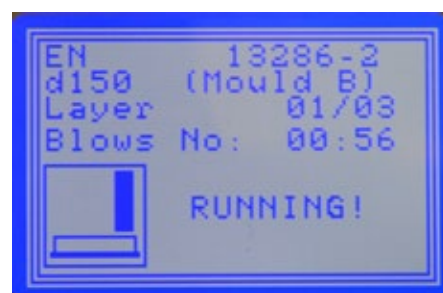
Apperçu d'une phase de compactage
