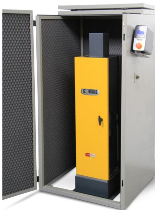
Compacteur automatique Proctor/CBR programmable 33-T3500 logé dans un cabinet d'insonorisation et de sécurité 33-T3000/CB
