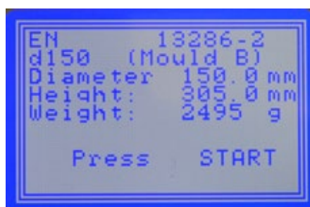
Paramètres de compactage
