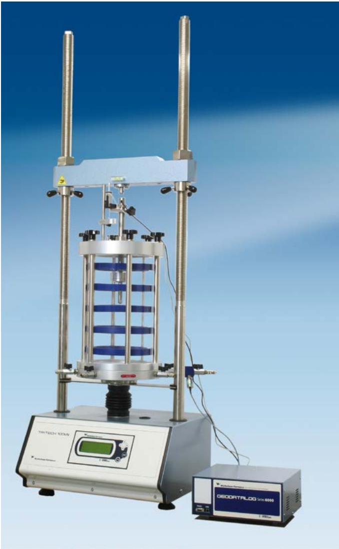
Modelo 28-WF4010, 100 kN con célula triaxial, célula de carga externa y transductor de desplazamiento.
