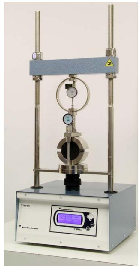
Presse 28-WF4001 en configuration analogique Marshall
