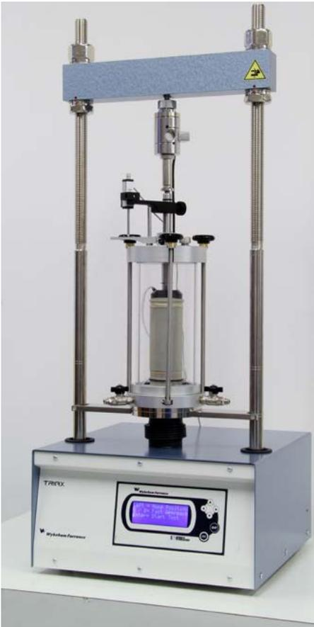
Presse triaxiale 28-WF4001 en configuration triaxiale digitale
