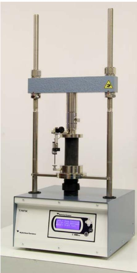
Presse 28-WF4001 en configuration digitale essai non-confiné
