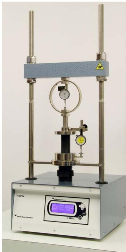
Presse 28-WF4001 en configuration analogique essai non-confiné
