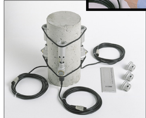
Цилиндрический образец диаметром 150 x 300 мм с 3 измерителями 55-C0222/F для проведения испытания на модуль упругости. На фото представлен механизм блокировки/разблокировки преобразователя.
