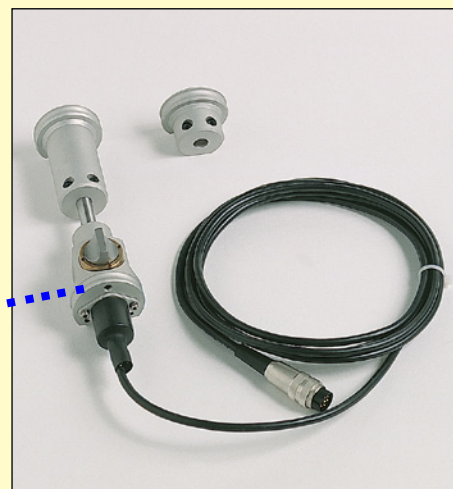
Измеритель сжатия/растяжения модель 50-C0222/F
