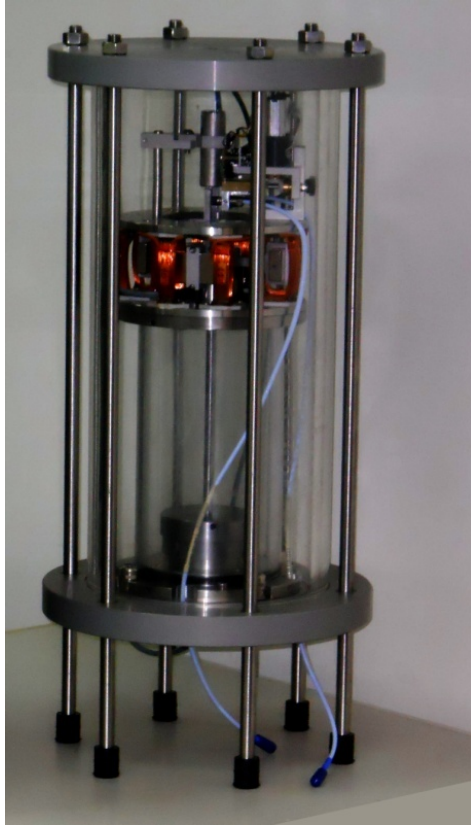
Sistema di colonna risonante cella più pannello di comando
