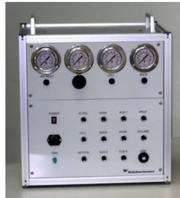
Sistema di colonna risonante cella più pannello di comando
