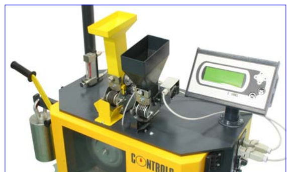
Détail des dispositifs d'alimentation
