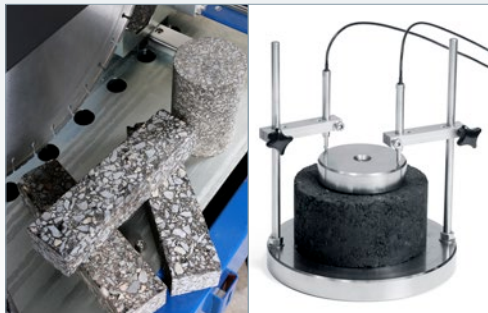
Cyclic Compression Test EN 12697-25:2005
