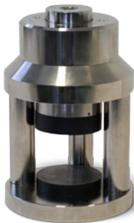
Tracción indirecta en muestras de roca conforme con ASTM D3967
