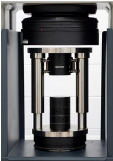
Dispositivo de compresión de alta resistencia conforme a ASTM D7012
