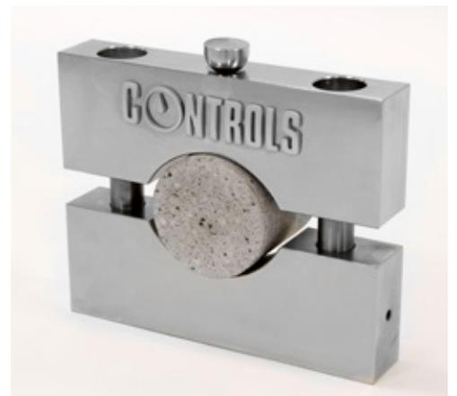
Tracción indirecta en muestras de roca NX conforme con ISRM
