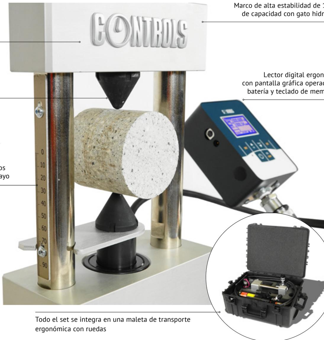
Marco de alta estabilidad de 100kN de capacidad con gato hidráulico
