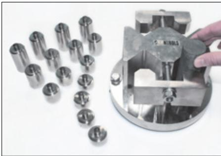
Dispositivo de sujeción para la preparación de la superficie del testigo.
