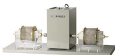
Aparato de índice de resistencia al desgaste
