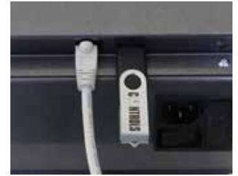
Dettaglio della porta LAN e della porta USB 2.0
