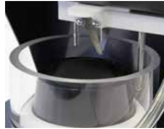
Dettaglio del nuovo accessorio per il test in acqua munito di dispositivo di pulizia dell'ago. Seguendo i suggerimenti degli utenti finali la funzionalità è sostanzialmente migliorata
