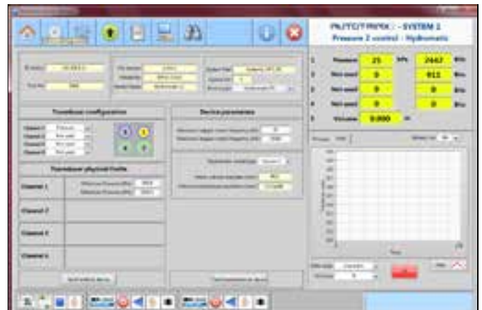
Panel de ajuste para la adquisición de datos presión/volumen y dispositivo de control mostrando ajuste para los cuatro canales
