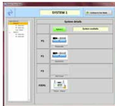
Panel de selección de sistema mostrando dos sistemas triaxiales disponibles, con una prensa triaxial Trittech compartida
