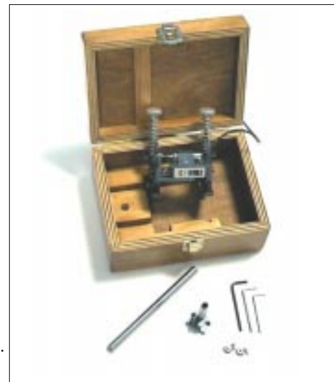
70-C954/C Estensimetro universale. Di facile e veloce utilizzo.
