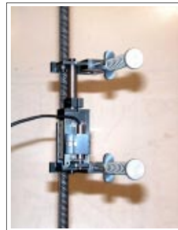
70-C954/C Estensimetro universale applicato a tondo per cemento armato.
